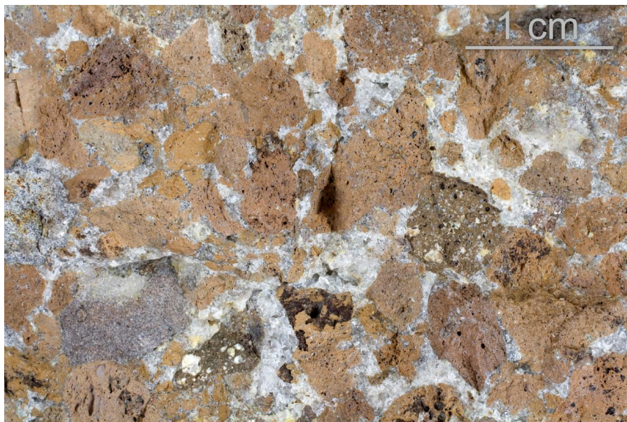
Abb. 8: Schlackenlapilli-Brekzie vom Silberberg-Steinbruch. Einzelne Schlackenklasten heben sich durch unterschiedliche Farbtöne voneinander ab. Bei den hellen Kristallen in den Zwischenräumen handelt es sich um Zeolithminerale und Calcit. (Foto: Olaf Tietz)
