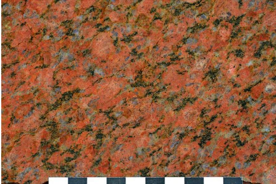
Abb. 4 Anschliff des Virbo-Granit-Findlings von Tetta. Die tektonische Deformation zeigt sich deutlich durch die diagonal zur Aufnahme verlaufende Streckung der Kalifeldspäte und die parallelen Biotitfasern (dunkel) und Quarzschnüre. An der linken Bildseite ist ein Feldspat nahezu vollständig von einem Quarzring umgeben (Pyterlitstruktur), und auf der rechten Seite treten zwei (geringfügig hellere) Plagioklase auf. Maßstab in cm-Einteilung. Foto O. Tietz
