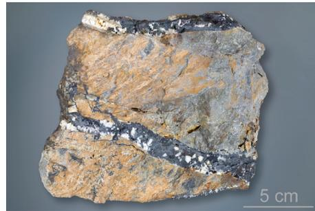
Abb. 8: Vorwiegend Manganminerale führende und Quarzfragmente einschließende Trümer in Kieselschiefer-Hornstein-Konglomerat, Fundstelle 7, Sammlung T. Giesler Nr. 2850.
